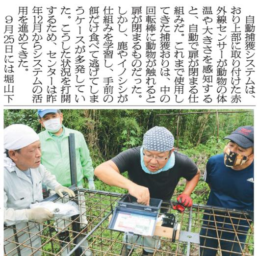
自動捕獲システムは、おりに取り付けた赤外線センサーが動物の体温や大きさを感知すると、自動で扉が閉まる仕組みだ。これまで使用してきた捕獲おりは、中の回転棒に動物が触れると扉が閉まるものだった。しかし、鹿やイノシシが仕組みを学習し、手前の餌だけ食べて逃げてしまうケースが多発していた。こうした状況を打開するため、センサーは昨年12月からシステムの活用を進めてきた。
