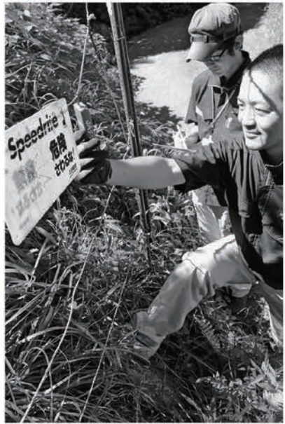
電圧計で電気柵の通電状況を確認するセンター職員
